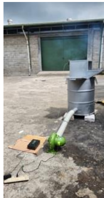
Gambar 5. Instalasi Insinerator sederhana
