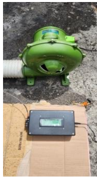
Gambar 4. Blower dalam instalasi Insinerator
